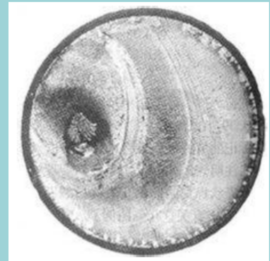
疲劳源位于构件的表面
